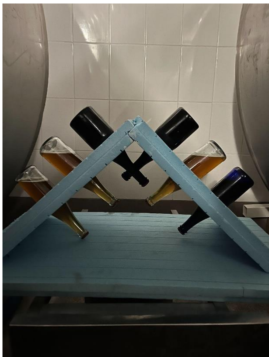
Рисунок 1.3.2 – Експериментальна установка для дозрівання та освітлення пива
